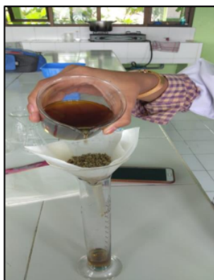
Gambar 3. Proses Filtrasi dengan Zeolit
