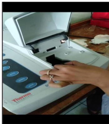
Gambar 5. Pengukuran Kandungan Logam Berat dengan Spektrofotometri
